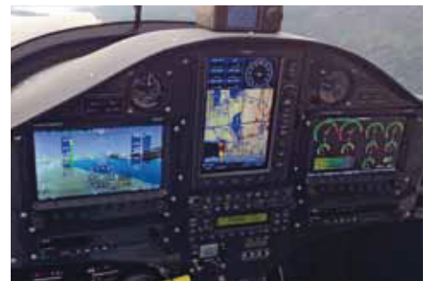
Das Cockpit wie ein Airliner: Auf dem Primary Flight Display (links) ist die Geografie, hier beim Bielersee, ebenso zu sehen wie auf dem Navigations Display (Mitte). Rechts ist die Motorenüberwachung aufgeschaltet.
